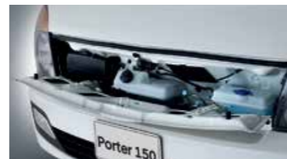
Ốp trước giúp dễ dàng quan sát và bảo trì các chi tiết bên trong.
