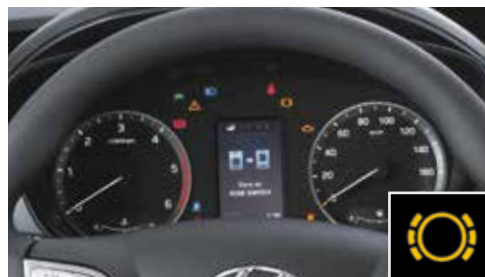
Cảnh báo má phanh mòn Chức năng an toàn này cung cấp một cảnh báo sớm để thay thế má phanh.
