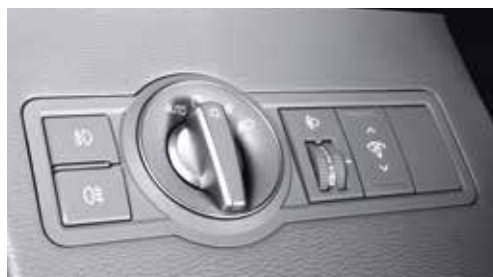
Cụm công tắc đèn pha kết hợp điều chỉnh độ cao đèn pha
