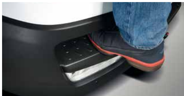
Bạc đứng phía trước giúp dễ dàng lau dọn, vệ sinh kính và mặt trước xe.
